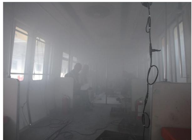
图4 列车内部全尺寸火灾实验烟气扩散情况
