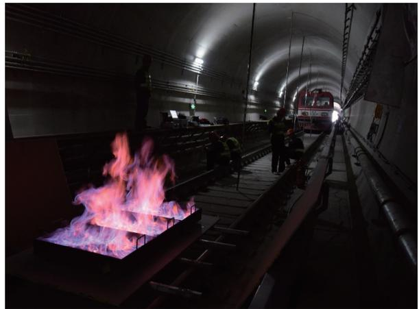
图 7 列车阻塞下地铁倾斜区间隧道全尺寸火灾实验
