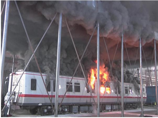
图 5 地铁列车单节车厢全尺寸燃烧实验
