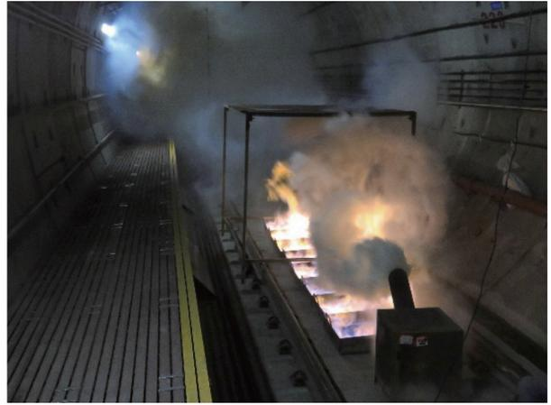
图 6 地铁长大区间隧道全尺寸火灾实验
