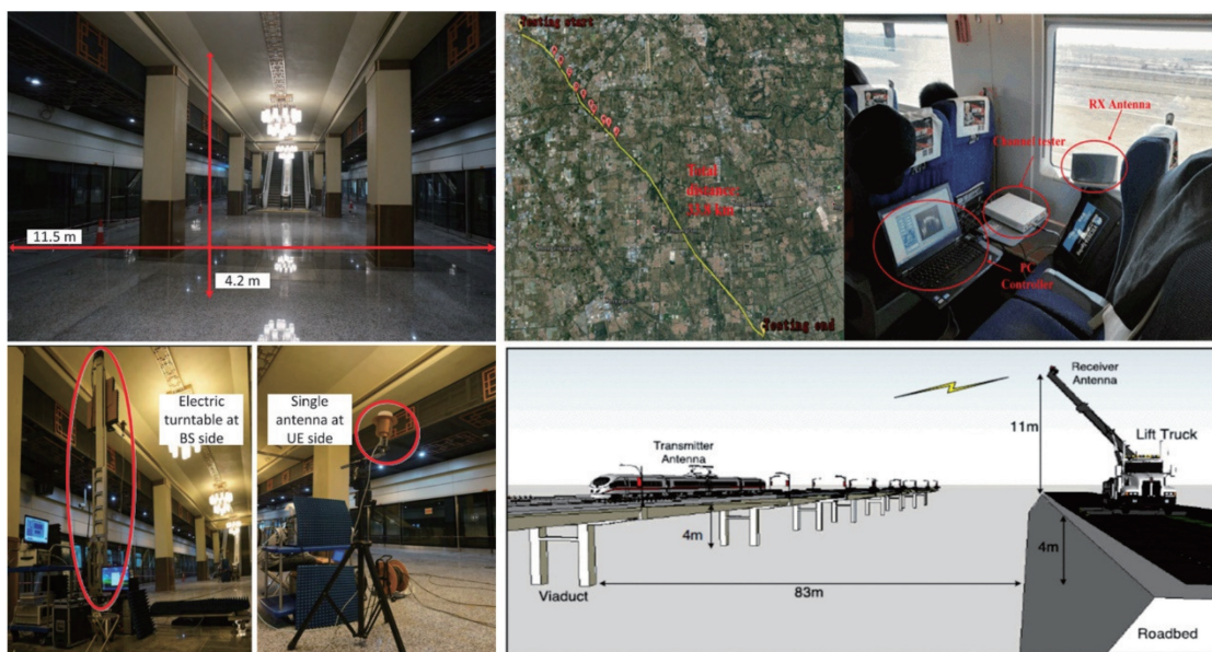
图3 面向 5G 的高速铁路场景信道测量示意图
